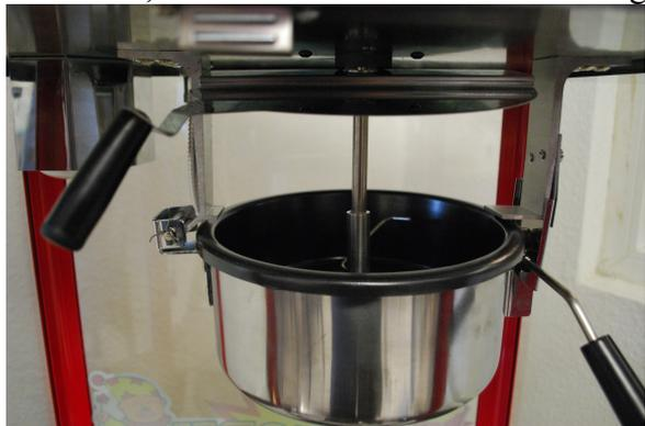
Dazu den linken Griff einfach nach oben führen, der Deckel sollte dann am oberen Magneten halten.
